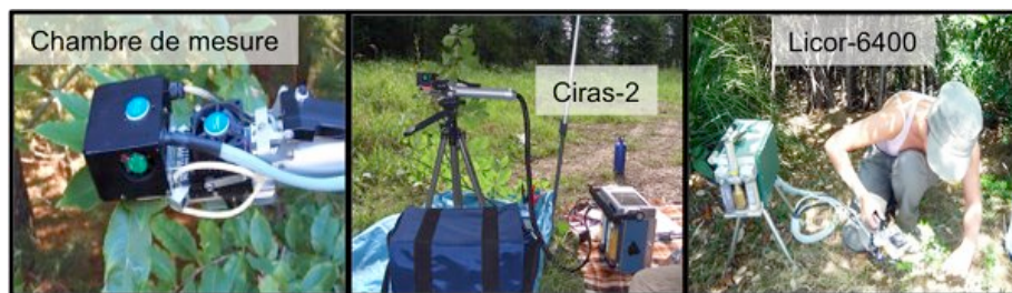
Figure 3-8 Illustration d'analyseur de gaz à infra-rouge (IRGA). De gauche à droite: une chambre de mesure (cuvette PLC6) Ciras-2, un ciras-2 et un Licor-6400.
